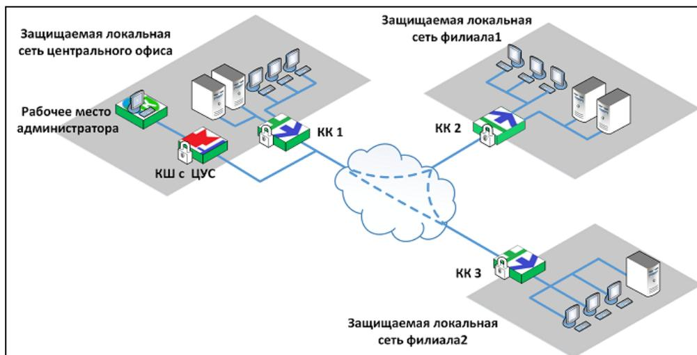
Внешний интерфейс криптокоммутатора направлен в сети общего доступа. К внутренним интерфейсам подключаются hosts защищаемых подсетей. Внутренние интерфейсы используются как порты коммутации в составе так называемого виртуального коммутатора.
