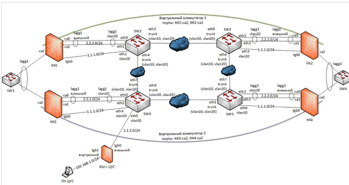
Криптокоммутаторы KK 1 и KK 3 внутренними интерфейсами ca2 подключены к агрегированному интерфейсу lagg1 устройства SW1. Аналогично криптокоммутаторы KK 2 и KK 4 подключены к SW6.
