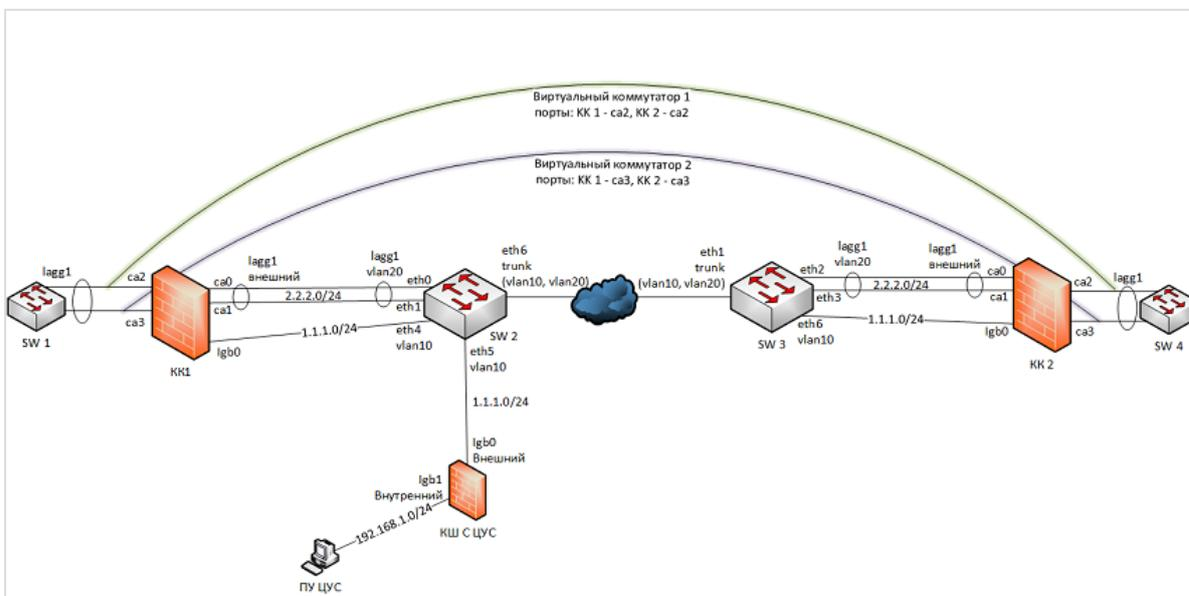
Криптокоммутаторы КК 1 и КК 2 внутренними интерфейсами подключены соответственно к коммутаторам SW 1 и SW 4 с агрегированными интерфейсами lagg1.
