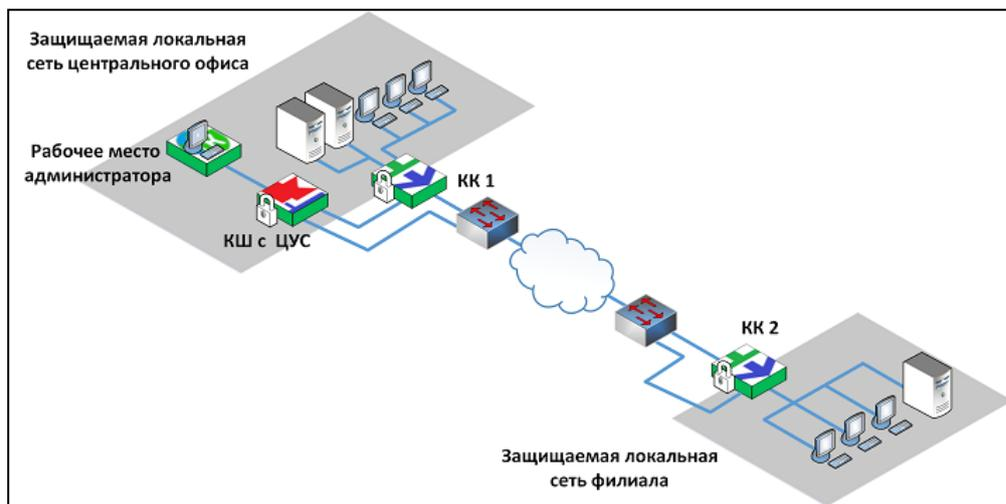
Для построения сети в программе управления ЦУС необходимо создать виртуальный коммутатор и включить в него внутренние интерфейсы криптоускорителей КК 1 и КК 2. Эти внутренние интерфейсы в виртуальном коммутаторе выполняют роль портов коммутации.
