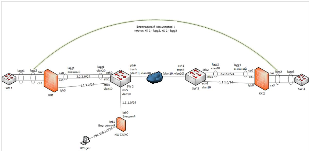
Интерфейсы са2 и са3 криптокоммутаторов КК 1 и КК 2 объединены в логический интерфейс lagg2.
