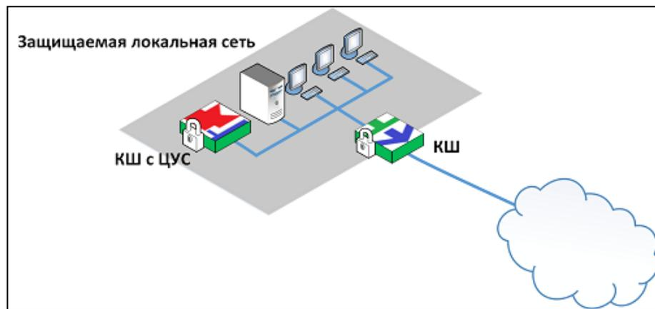
Второй вариант является предпочтительным, так как снимает с КШ, работающего как шлюз, нагрузку, связанную с выполнением функций ЦУС.
