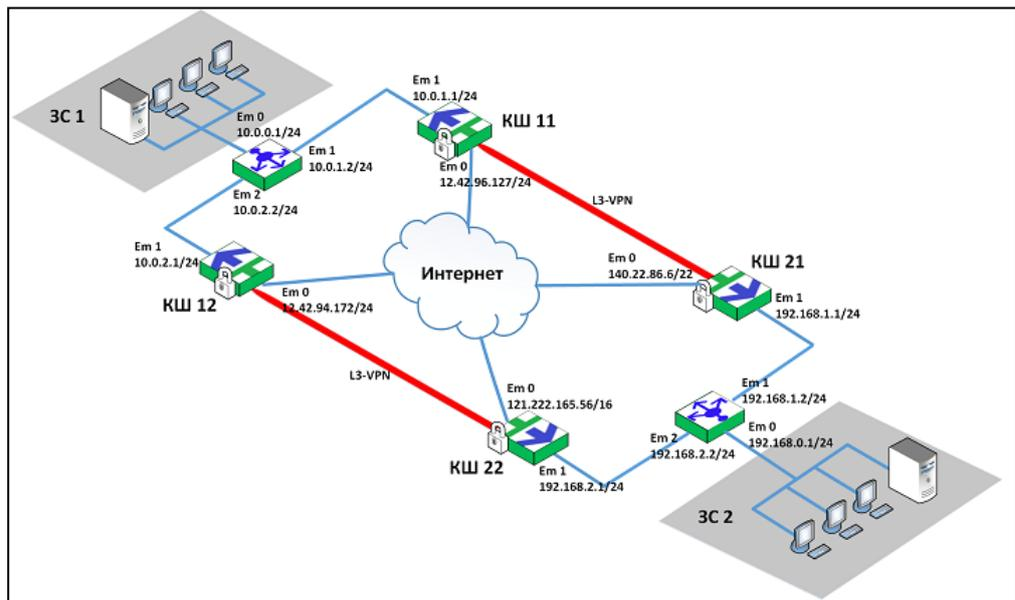
В каждой защищаемой сети устанавливают по одинаковой ферме. Нагрузка распределяется между КШ в ферме. Ферма состоит из нескольких КШ и балансировщика, распределяющего пакеты из защищенной сети между данными
