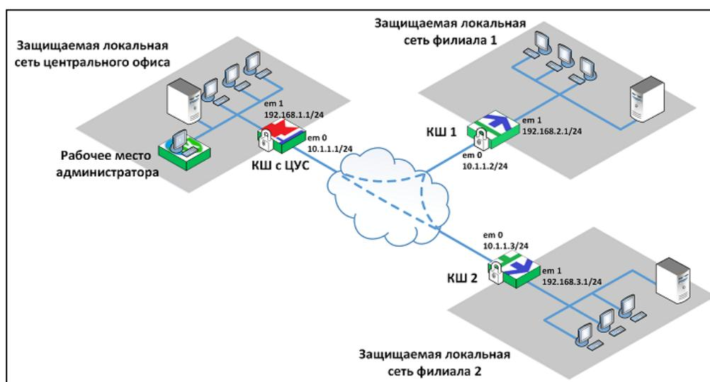
На схеме для каждого криптошлюза указаны его внешний и внутренний интерфейсы.
