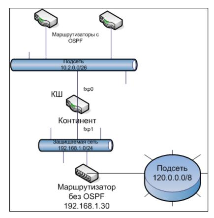
Для того чтобы обеспечить динамическую маршрутизацию при прохождении трафика между подсетью 120.0.0.0/8 и другим удаленным филиалом, на КШ должна быть выполнена настройка динамической маршрутизации.
