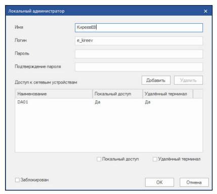
**2.** В свойствах учетной записи администратора выберите требуемые сетевые устройства и установите отметку в поле "Удаленный терминал", затем нажмите кнопку "ОК".
