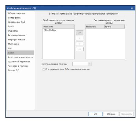
В этом окне осуществляют формирование списка связанных сетевых устройств, а также настройку параметров соединений с ними. В поле "Время" отображается время установки ключа парной связи, на котором осуществляется криптографическое соединение с этим устройством.
