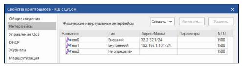
**Примечание.** Имена интерфейсов, отображаемые в таблице, соответствуют именам, указанным на корпусе сетевого устройства рядом с каждым разъемом.
