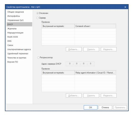
На вкладке отображается установленный для данного устройства один из трех возможных режимов работы сервиса DHCP:
