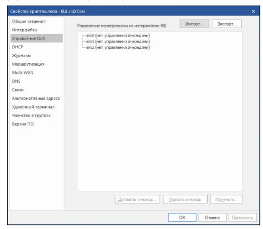
На вкладке отображается иерархический список сетевых интерфейсов данного устройства и действующих на них очередей. Для формирования очередей используйте кнопки:
