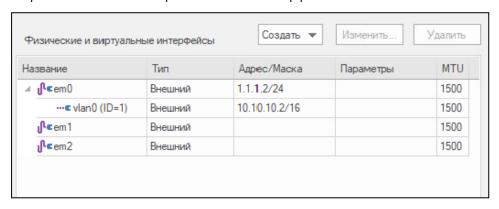
Зарегистрированные VLAN-интерфейсы отображаются с названием vlanN, где N — номер, присваиваемый при регистрации.
