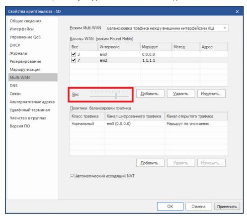
Удаление отметки в левой части записи отключает использование данного канала без удаления записи из списка.
