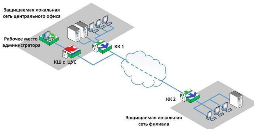
Для построения сети в программе управления ЦУС необходимо создать виртуальный коммутатор и включить в него по одному внутреннему интерфейсу криптокоммутаторов КК 1 и КК 2. Эти внутренние интерфейсы в виртуальном коммутаторе выполняют роль портов коммутации.
