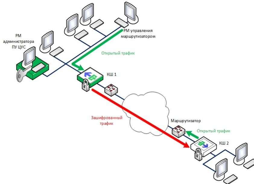
Таким образом, исходный управляющий трафик от консоли управления зашифровывается криптографическим шлюзом КШ 1 и по общей сети передается в зашифрованном виде на КШ 2. Криптографический шлюз КШ 2 расшифровывает трафик и передает его в открытом виде на маршрутизатор. IP-пакеты отсылаются маршрутизатором к консоли управления тем же путем в обратном порядке.
