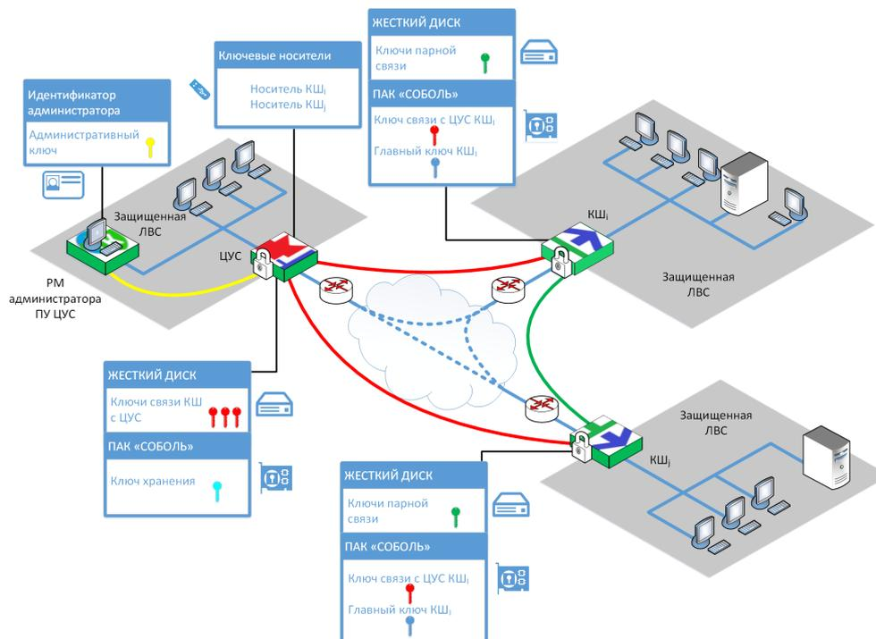
При работе комплекса используется симметричная криптографическая система. Криптографическое соединение между двумя КШ в сети осуществляется
