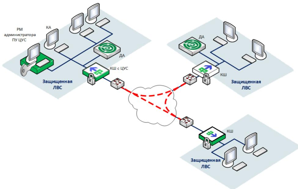
Связь между ЛВС осуществляется по каналам связи общих сетей передачи данных. К общим сетям каждая ЛВС подключена через криптографический шлюз. Подключение ЛВС через криптографический шлюз обеспечивает скрытие внутренней структуры защищаемого сегмента сети. При этом IP-адреса устройств в защищаемых сегментах должны быть уникальными только в рамках данной корпоративной сети.
