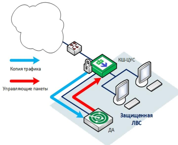
Передача управляющих пакетов COB в контролируемую сеть (сетевой сегмент) осуществляется в обратном порядке через SPAN-порт или через дополнительный сетевой интерфейс системы обнаружения вторжений (атак), настроенный специальным образом.
