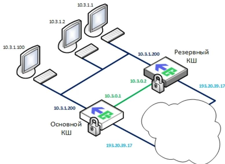
Если оба КШ расположены в одной серверной стойке, для их соединения используется сетевой кросс-кабель. В остальных случаях соединение криптографических шлюзов осуществляется через IP-сеть.
